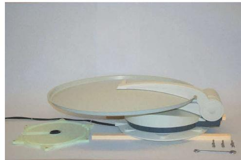
3. Schrauben (6 Stück, SW 10) der Montageplatte öffnen und Montageplatte abnehmen.
